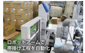
ロボットアームで吊掛け工程を自動化
